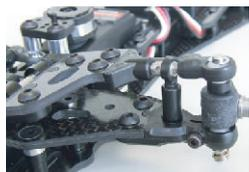
小型フリクションダンパーを装備したF-1用SDSフロントエンドを装備。樹脂部品とカーボンプレートによるハイブリッド構造を採用したフロントサス。
