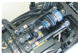
高精度HGチューブダンパーをクランク部品を使用しデュアルマウント。スムーズな作動と安定した効きでロールを絶妙にコントロールする。
