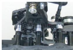
ロアサスアーム下のシム調整により、フロントの車高調整が自由に行える。小径タイヤ時にも十分な車高を確保する事が可能。
