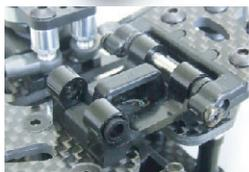
ボールコネクト形式のフロントバルクヘッドを採用。シム調整により前後のバルクの高さを変更する事が可能。アッパーアームの迎角も調整可能。
