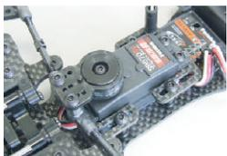
アッカーマンを無段階に調整する事ができるスライド式サーボマウントを採用。各社ロープロサーボ及びJRサイズのミニサーボが搭載可能。
