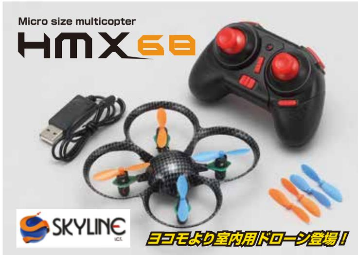
SKYLINE ICS の室内用マルチコプター “HMX68”。全長 98mm のコンパクトな機体を 4 枚のプロペラ駆動で飛行する、マイクロサイズ ドローンです。高性能 ジャイロ制御による高い安定感で、誰でも簡単に飛行を楽しむことが可能。スイッチ操作でアクロバティックな 4 方向フリップ (宙返り) も簡単にできちゃいます。もちろん送受信機も付属した完全完成済みのレディトゥフライで、詳しい日本語取扱説明書も付属していますから、メカや配線に不慣れな方でも安心してお楽しみいただけます。カラーバリエーションはカーボン柄、ピンク、イエローの 3 色で、バッテリー充電用の USB ケーブルも付属し、パソコンなどの USB コネクターや汎用 USB 電源などから急速充電が可能。約 40 分の充電時間で、5 分前後の飛行が可能です。補修用プロペラ 4 枚付き。
