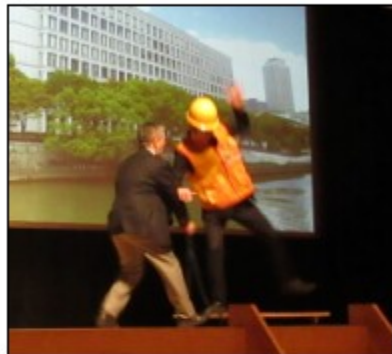
台車の上で人間振動実験。 高く不安定だと倒れやすい。
