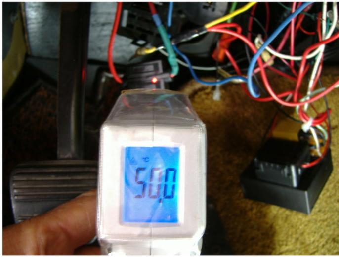
まだ修理は完了していません 😞電流を測定してみると16アンペア流れています、温度も50℃を超えています、やはりブロアモーターが元の原因です。
