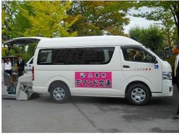
車両はリフト付き車両と、セダンの車両がそれぞれの地域で1台ずつ、合計4台で運行します。リフトには、車椅子に座ったまま乗車できます。
